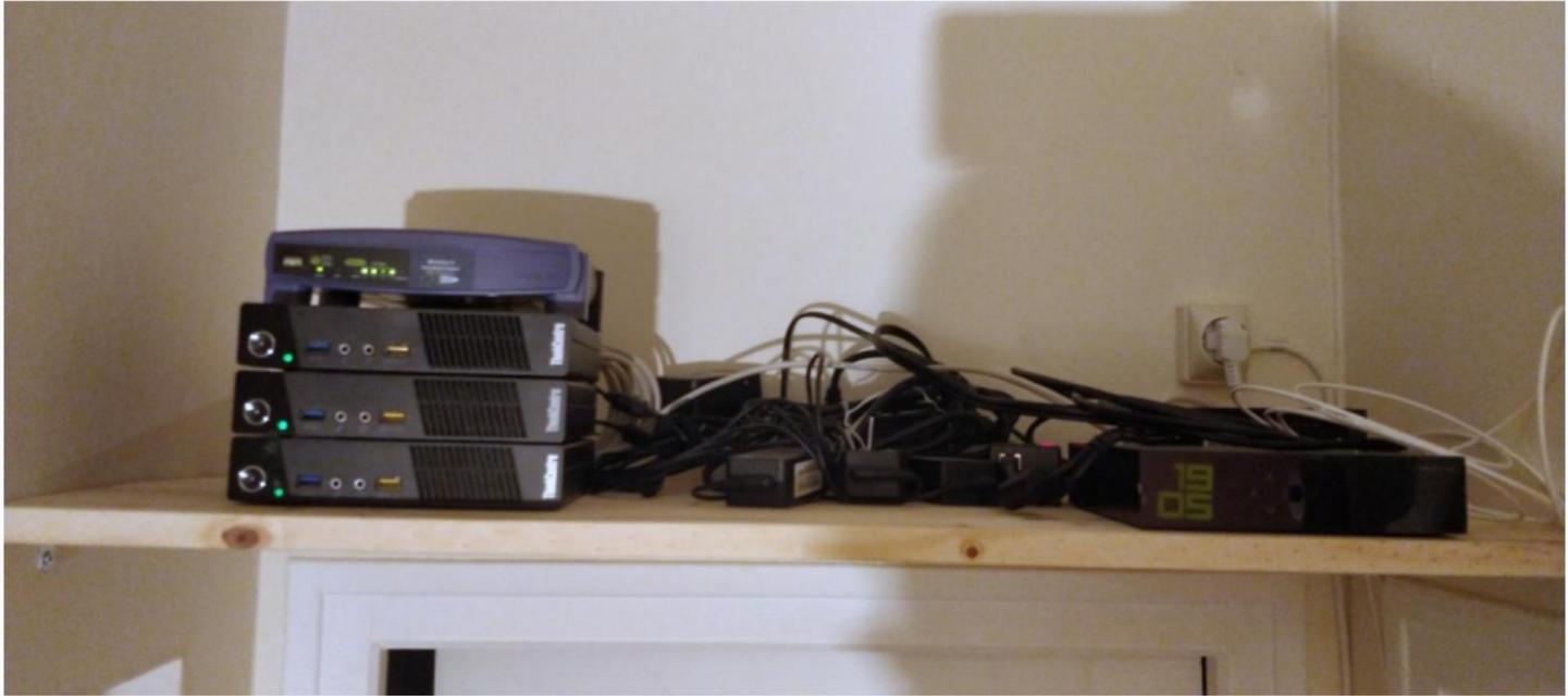
**Figure 2:** Site Deuxfleurs avec 3 serveurs (PC de bureau reconditionnés) et 2 routeurs
